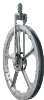
Dispositivo de puesta a tierra con disco y escobilla de carbón (descarga eléctrica 20 kA/0.4 s)
